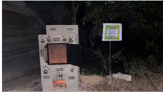
Gambar 1. Rocket Stove setelah jadi
