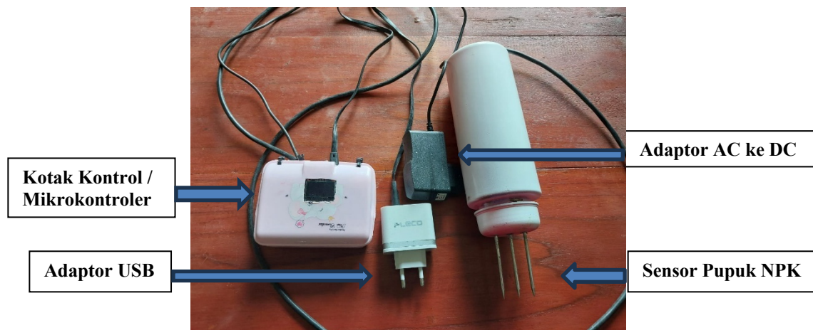
Gambar 7. Alat Pendektesi Kadar NPK pada Pupuk Organik Daun Sawit
