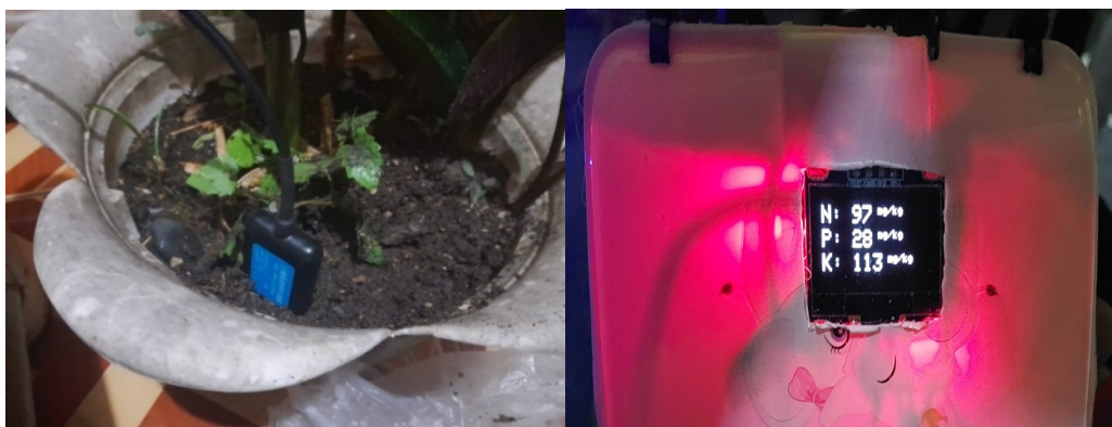
Gambar 6. Uji Sensor NPK Soil pada Pupuk Organik Daun Sawit
