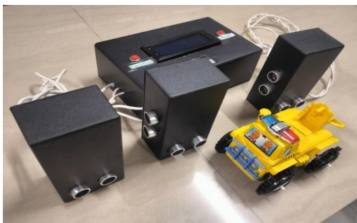
Gambar 6. Alat peraga kecepatan dan percepatan berbasis arduino uno dengan sensor ultrasonik HCSR-04
