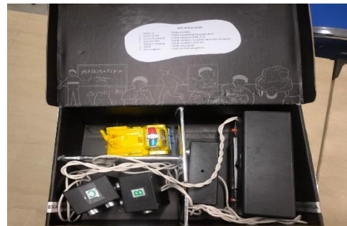
Gambar 6. Alat peraga kecepatan dan percepatan berbasis arduino uno dengan sensor ultrasonik HCSR-04
