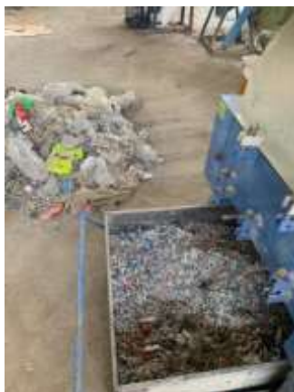
Gambar 3. Proses Pembuatan Packing Block yang Berasal dari Sampah
