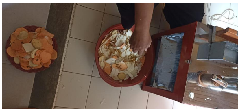
Gambar 2. Hasil pemotongan ubi dan singkong menggunakan alat pemotong otomatis
