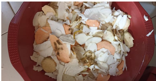
Gambar 3. Hasil pemotongan buah pisang yang tidak beraturan pada saat uji coba awal alat pemotong
